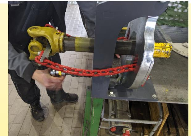
Bringen Sie die Abdrückspindel in die hintere Position. Schieben Sie die Gelenkwellenhälfte zuerst durch die Spanneinrichtung und dann durch die Abziehplatte. Anschließend mit der Spannschraube fixieren.
