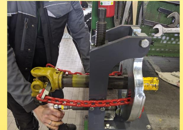
Das Kettenstück mit der Zugbrücke in die Gabel einführen und in die Abziehplatte einhängen. Die Einhänglänge so kurz wie möglich wählen. Hängen Sie das lose Kettenstück in gleicher Länge sowohl in die Zugbrücke als auch in die Abziehplatte ein.
